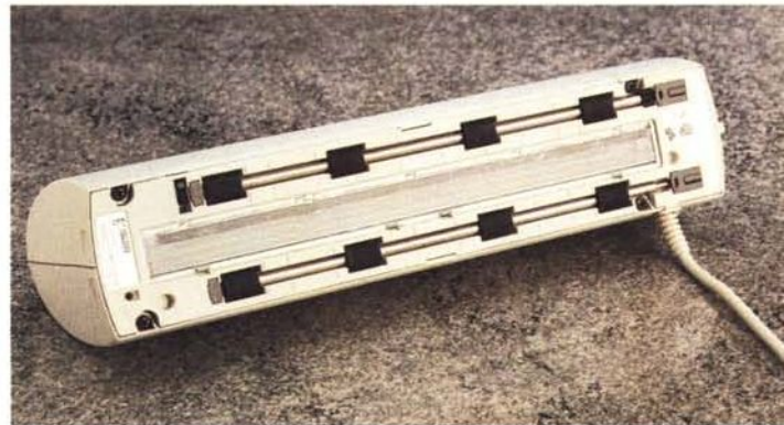
La testa mobile dello scanner vista dalla parte inferiore.
